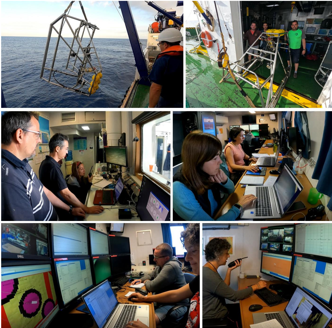
Figura 18. Trineo Horus del Centro Oceanográfico de Cádiz en el laboratorio húmedo, tras ser largado por el costado de estribor (arriba). Manejo del trineo Horus desde el laboratorio multipropósito (medio izquierda) y procesamiento preliminar de imágenes submarinas en el laboratorio de acústica (medio derecha). Posicionamiento de los transectos de trineos mediante el uso del Hypack (abajo).
