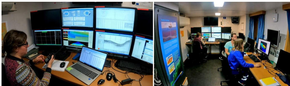
Figura 20. Detalles de la adquisición y procesado de datos acústicos (ecosonda multihaz y sonda paramétrica TOPAS) en el laboratorio de acústica del B/O Ramón Margalef.
