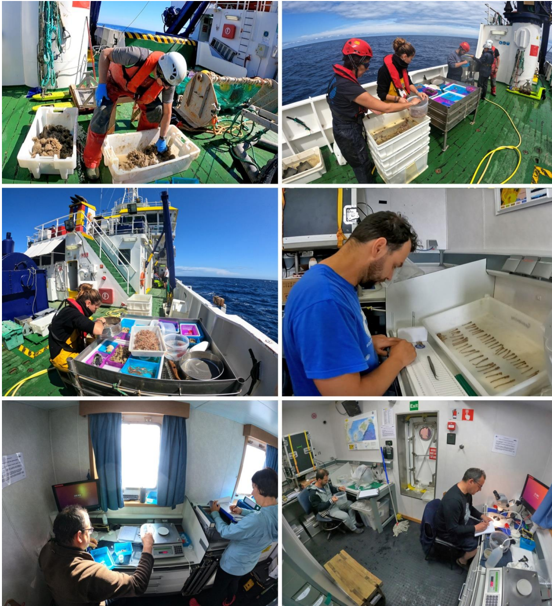
Figura 27. Procesado de las muestras recogidas con el beam-trawl en cubierta (arriba izquierda), incluyendo la separación de la muestra por fracciones de tamaño mediante lavado en una torre de tamices (arriba derecha) y por especies usando bandejas (medio izquierda). Medición de especies constructoras de hábitats recogidas con el beam-trawl en el laboratorio multipropósito (en la foto mediciones del pennatuláceo Kophobelemnon stelliferum ) (medio derecha). Identificación, cuantificación y pesado de las especies de pequeño tamaño en el laboratorio multipropósito (abajo).
