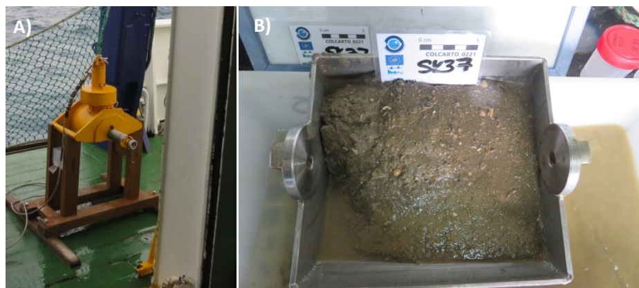
Figura 8. Draga Shipek utilizada durante la campaña INTEMARES_COLCARTO_0221 para la recogida de muestras de sedimento del fondo marino (A) y ejemplo de muestras obtenidas (B).
